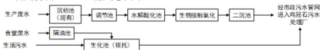
图 4.2-2 项目废水处理工艺流程示意图
