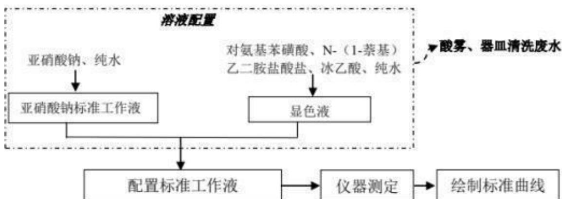
图 2-7 标准工作液配置流程图
