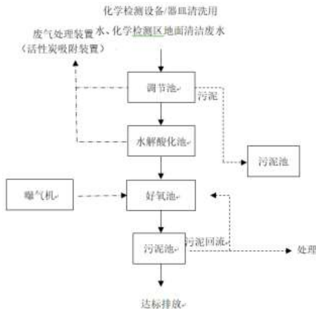
图 4.2-3 污水处理站处理工艺流程图
